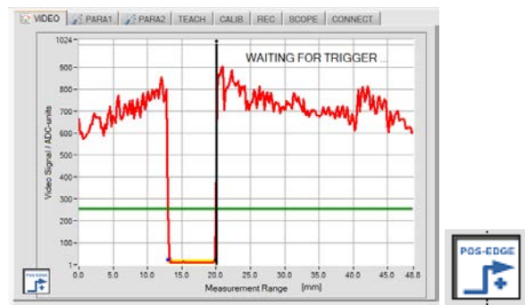
POS-EDGE L/H-TRIGG bei 20.0mm, Objekt: Durchmesser-Bestimmung D
